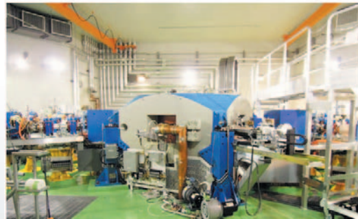
千葉工場に導入した新サイクロトロン
