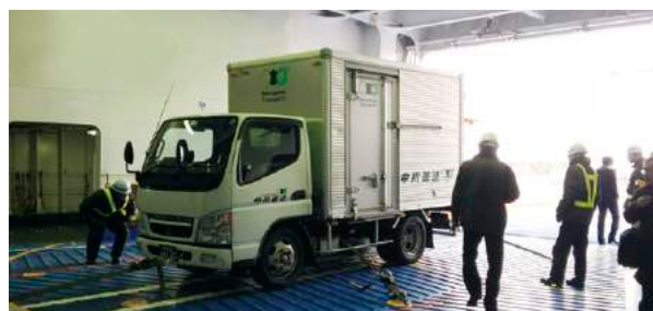
▲船内での車両固定状況
