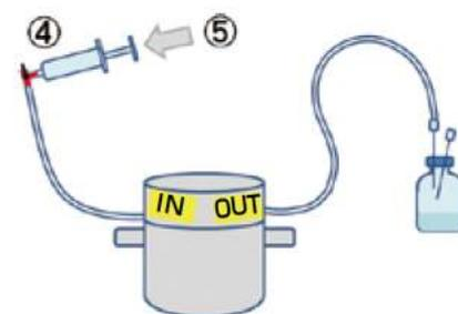
3 ディスポシリンジを用い<sup>81m</sup>Krの溶出を確認します。
