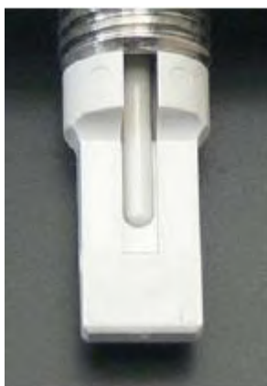
図 11-1 カートリッジD型をマガジン側より見ると、シードが1本残っているのがわかりません。
