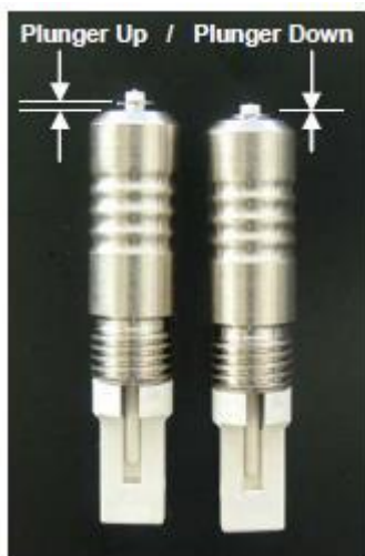
図 11-3 プランジャーの位置からシードがまだカートリッジ内にあるか確認できます。
