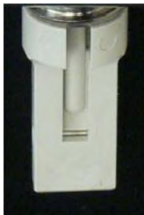
図 11-2 カートリッジD型をカートリッジ・ヘッド側より見ると、シードが1本残っているのが確認できます。
