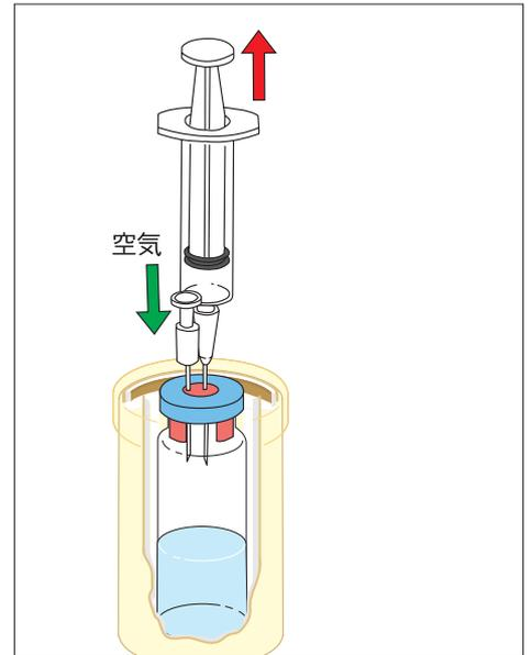
4. 3の操作後、注射筒のプランジャーを引き、バイアル内のガス2mLを抜き取る。これにより通気針を通じ無菌の空気が導入される。
